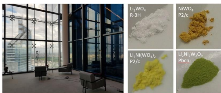
Figure 1 : (à gauche) Sageglass® installé en façade de la tour Saint-Gobain dans l'état clair (gauche de l'image) et l'état sombre (droite de l'image), Paris La Défense. (à droite) Couleur d'oxydes mixtes nickel, tungstène ou nickel-tungstène obtenus par synthèse de poudres.
